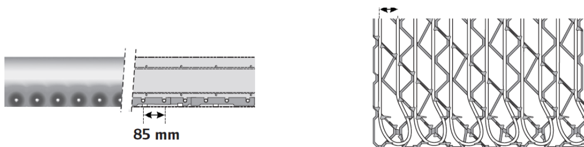
Obr. 6 Vynechání systému v místě s vyšším zatížením, r=600\text{mm} , rozteč potrubí
